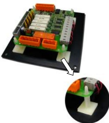
**E: DESCRIPCIÓN** Módulo electrónico que supervisa el correcto funcionamiento de las luces de navegación, módulo para hasta 5 luces, indicando mediante LEDs si están encendidas o mediante intermitencia del correspondiente LED si estando activado el correspondiente interruptor o magneto hidráulico, la luz está fundida.
